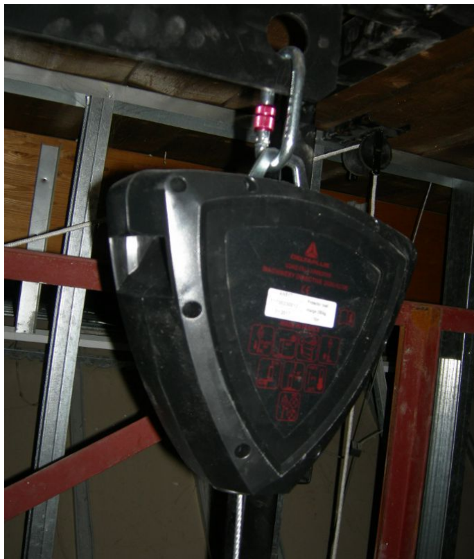
Foto 03 – Particolare di aggancio del “paracadute” tipo Deltaplus di portata max 250 kg
